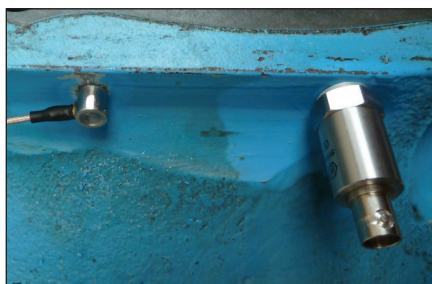
Snímače AE a vibrací při měření na tělese reduktoru
