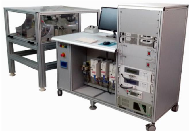
Zařízení IDS jsou ideálním testovacím řešením pro každý typ elektrického motoru poskytujícím skutečná měření výkonu motoru bez použití modelování. Díky velmi rychlému testovacímu cyklu (méně než 5 s) a přesnosti zařízení MEA Inertial Dynamometer jsme mohli vyvinout naše systémy MotorLine, abychom splnili požadavky testování všech 100% motorů na montážní / výrobní lince.
