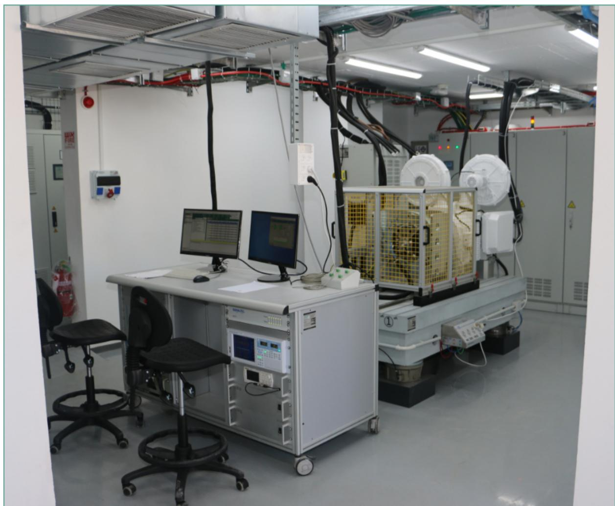
Příklad uspořádání zkušební stolice pro motory 1-140 kW
